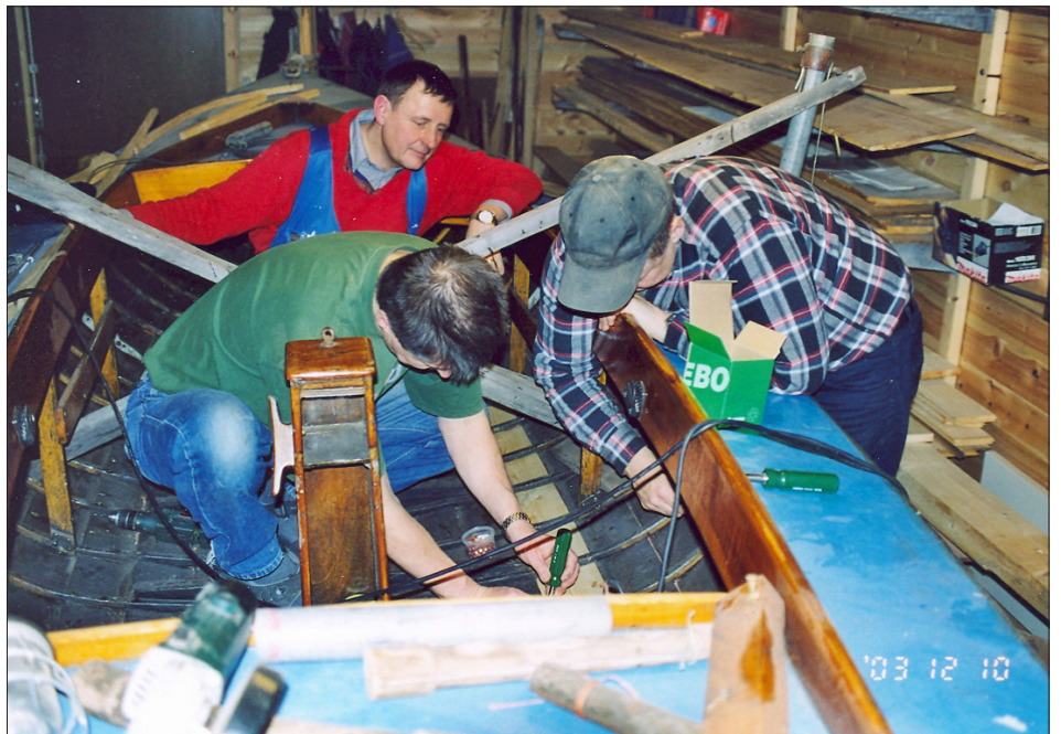
Under vintern utförs diverse reparationer av båtar. Här byts ett bord på en slända. Fr v Roger Stridfelt, Tore Öqvist och Sven-Olov Hederyd. Foto: Börje Nilsson.
